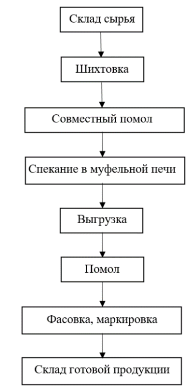
Рисунок 27 – Технологическая схема получения высокоглиноземистого клинкера
