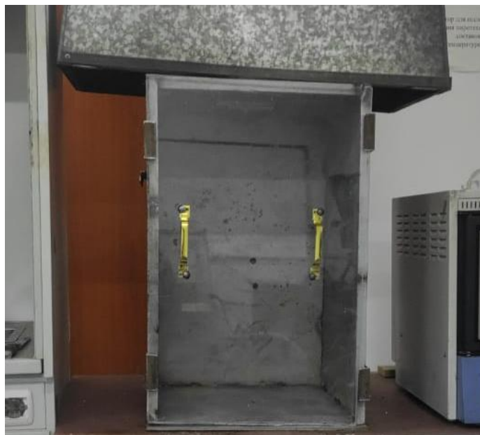
Рисунок 2 - Схема установки камеры сжигания и система, обеспечивающая получение дымовой составляющей газов
